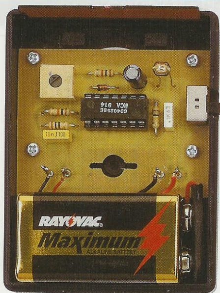
Fig.1 In questa foto potete vedere il circuito LX.1534, inserito all’interno del suo mobile plastico. Si noti la minuscola fotoresistenza montata sul circuito stampato e, in basso, la pila da 9 volt.
