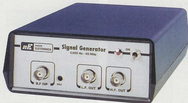
Fig.26 Vista frontale del mobile plastico al cui interno è inserito il Generatore BF-VHF. Il primo BNC a sinistra vi serve per applicare un segnale BF per poter modulare in AM i segnali BF-VHF che preleverete dai due BNC indicati LF Out e HF Out.
