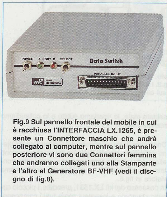
Fig.8 Se sull'uscita del computer volete collegare oltre al Generatore BF-VHF anche una Stampante, vi consigliamo di montare l'INTERFACCIA LX.1265, che commuta 2 PORTE PARALLELE. Questo kit è stato presentato sulla rivista N.186.
